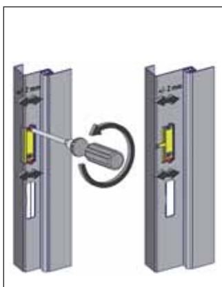
Állítható zárlemez Megkönnyíti az ajtólap beállítását, optimalizálja az ajtó nyomását a gumitömítésre, jobb hanggátlási értéket érhetünk el.
